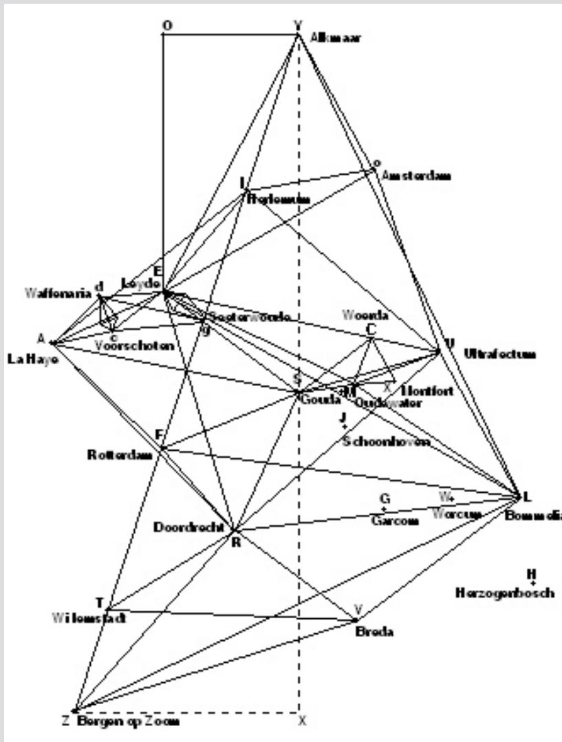
Figure 11. Le réseau de vingt-trois tours proéminentes de villes des Pays-Bas choisies par Snell, et les distances tracées entre les positions individuelles qu'il calcula par la méthode d'élargissement de la base.
