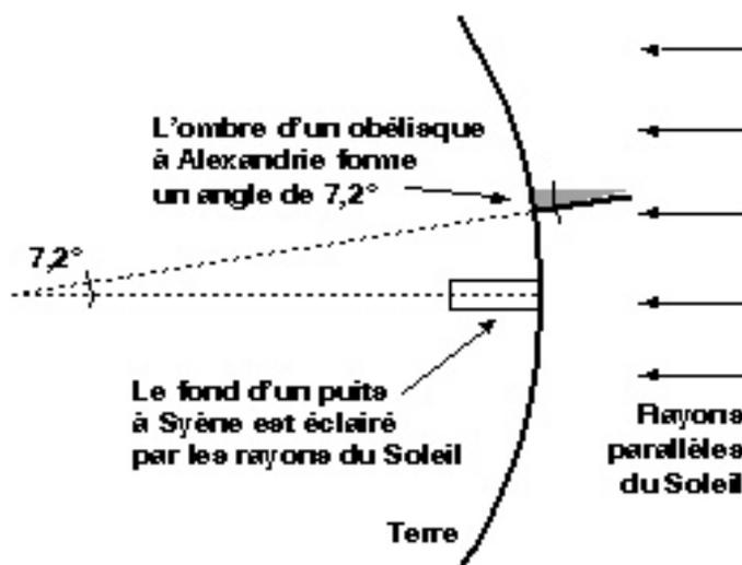
Figure 3. La mesure par Eratosthène de la circonférence de la Terre reposait sur le calcul de l'angle de l'arc entre Alexandrie et Syène (Assouan) situées sur le même méridien, séparées par une distance d'environ 833 km.
