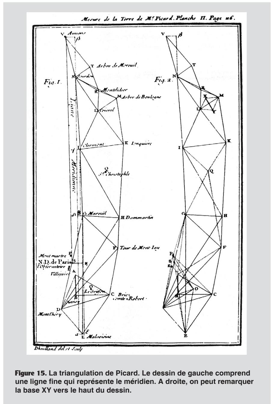
**Figure 15.** La triangulation de Picard. Le dessin de gauche comprend une ligne fine qui représente le méridien. A droite, on peut remarquer la base XY vers le haut du dessin.
