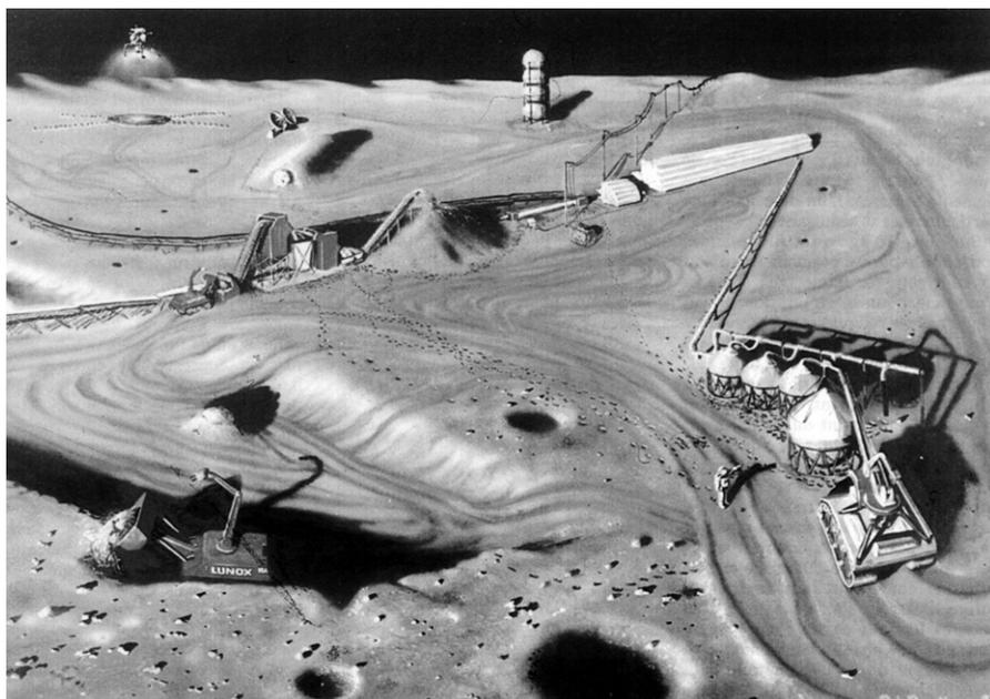
**Projet d'installation d'extraction d'oxygène à la surface de la Lune. Le minerai lunaire est prélevé, trié et traité. L'oxygène liquide est ensuite stocké dans les réservoirs au premier plan à droite.**
