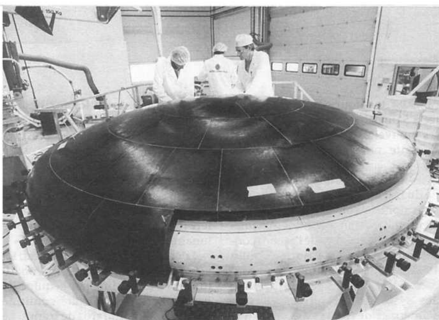
Le bouclier thermique de l'ARD, conçu par Aerospatiale, doit être embarqué lors du deuxième vol d'essai d'Ariane 5.
