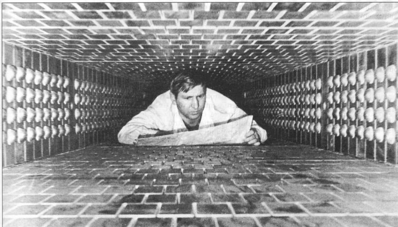
La tuyère de l'U-25 soviétique. Les protubérances rondes sur les côtés sont les électrodes segmentées. La tuyère est recouverte de briques en céramique.
