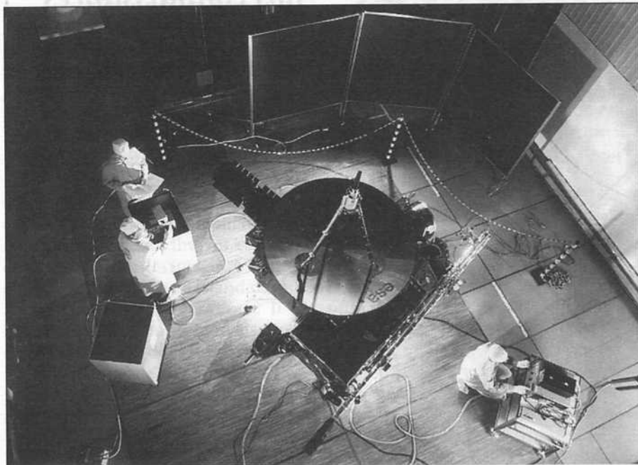
La sonde Ulysse en préparation au sol. A cause des conditions hostiles régnant dans le milieu interplanétaire et dans la ligne d'éjection des pôles solaires (protons et électrons très énergétiques), Ulysse comporte une part « d'électronique durcie ». Cependant, les systèmes de protection de ses instruments ont été fixés au minimum indispensable, afin de ne pas pénaliser sa charge utile.
