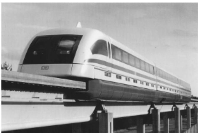
**Le système allemand Transrapid. Le rail de guidage, est constitué par des poutres d'acier en forme de T.**
