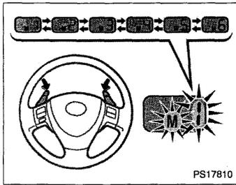
Contacteur de changement de vitesse au volant (modèles à 6 vitesses)
