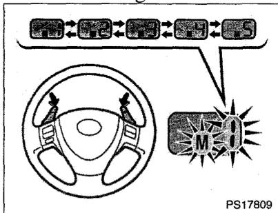
Contacteur de changement de vitesse au volant (modèles à 5 vitesses)
