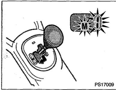
Les rapports ne changent pas automatiquement. Pour changer de vitesse, le conducteur doit actionner le levier de changement de vitesse dans le sens "+" ou tirer le contacteur de changement de vitesse au volant "+" ou "-". Comme sur les véhicules à boîte de vitesses mécanique traditionnelle, relâcher légèrement la pédale d'accélérateur contribue à un changement de vitesse plus souple.
