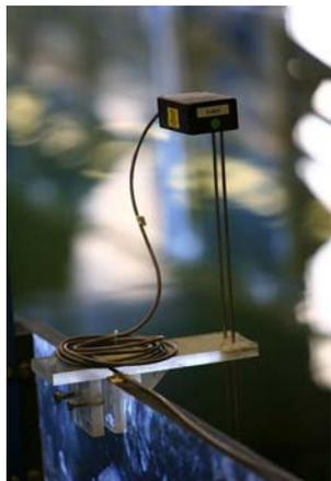
• Le modèle est instrumenté et informatisé afin d'acquérir des informations à haute fréquence (200 à 300 informations par seconde) et des mesures de vitesses toujours plus précises sur :
