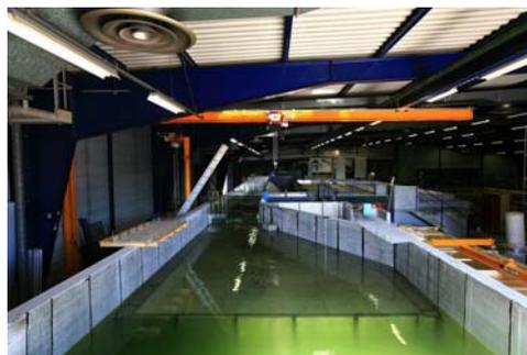
Il est composé de 2 sas d'écluses de gabarit Post-Panamax : 1 écluse amont et 1 écluse aval pourvue de 3 bassins d'épargne et de l'ensemble du système hydraulique : prise d'eau, aqueducs, larrons, vannes. Cette configuration optimale permet de simuler et d'étudier tous les scénarios d'exploitation future.
