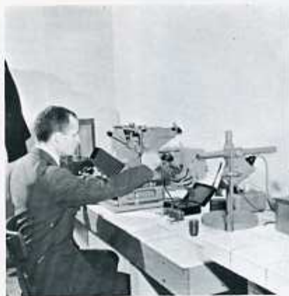
Analyse au microscope métallurgique de la structure des aciers.
