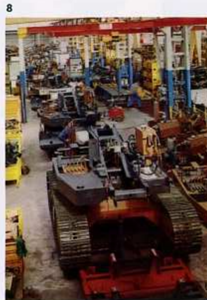
Habillés sur des chaînes parallèles, les châssis-porteurs et les châssis-tourelles sont ensuite assemblés sur la chaîne de montage.
