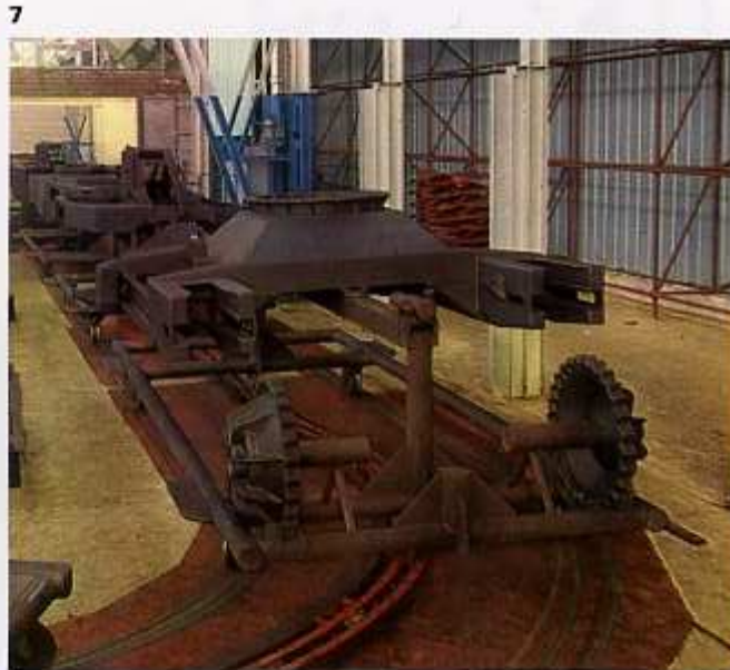
Après leur passage dans une cabine de grenailage, les châssis-porteurs et les châssis-tourelles reçoivent une peinture d'apprêt anti-corrosive.
