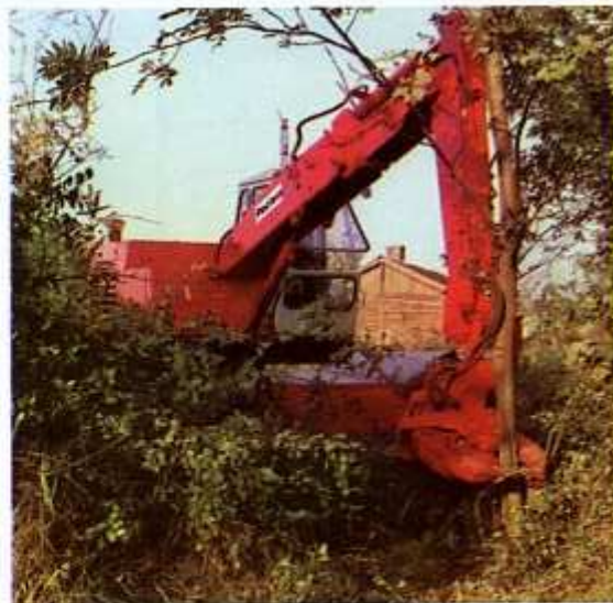
Travaux agricoles : débroussaillage au sécateur hydraulique qui coupe les arbres jusqu'à 0,25 m de diamètre.
