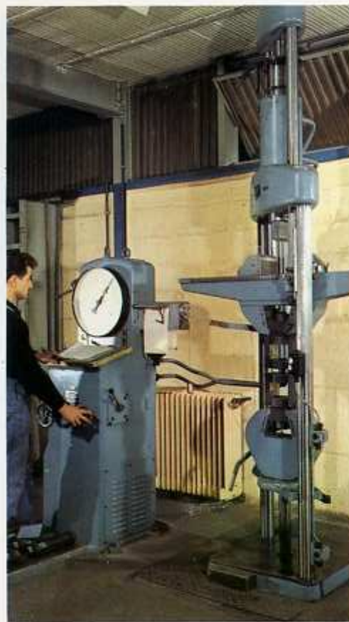
Les propriétés physiques et chimiques des matières premières et des pièces sont analysées dans le laboratoire du Service Qualité. Ci-contre : machine de traction - force : 30 tonnes.
