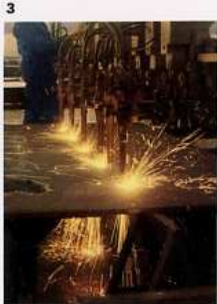
Les tôles sont débitées par 4 mégatomes III d'oxycoupage à 6 becs et double poste de travail disposés en ligne.
