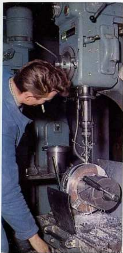
Perceuse à colonne G.S.P. équipée d'une table mobile et d'un diviseur pour le perçage en gabarit des couronnes intérieures de joint tournant.
