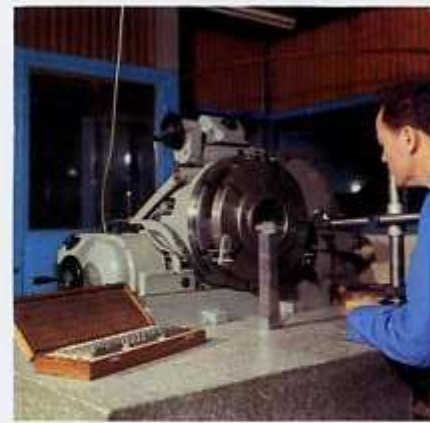
Contrôle d'un bloc cylindre de moteur hydraulique sur un diviseur optique précision = 1 seconde. L'opérateur procède ici au relevé des équidistances des alésages pistons.
