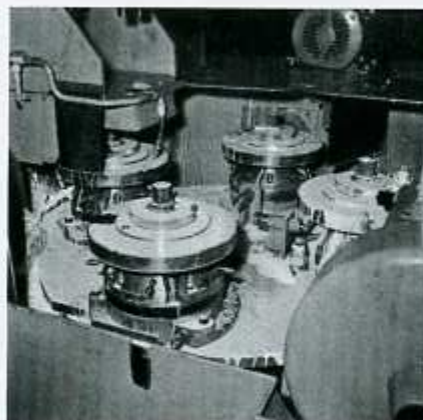
Machine Renault à transfert circulaire et à quatre postes de travail exécutant automatiquement les perçages, alésages et fraisages des blocs-cylindres des moteurs hydrauliques.
