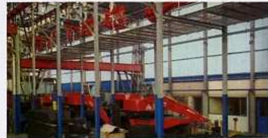
Habillés sur des chaînes parallèles, les châssis-porteurs et les châssis-tourelles sont ensuite assemblés sur la chaîne de montage.
