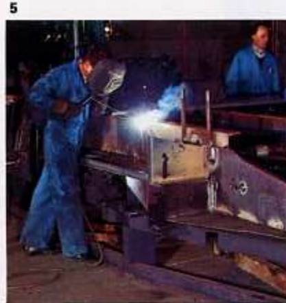
Châssis-porteurs et châssis-tourelles sont assemblés et pointés sur gabarits pour obtenir des ensembles rigoureusement identiques.
