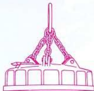
■ ELECTRO-AIMANT Avec adjonction d'une génératrice sur la machine
