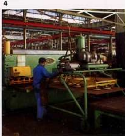
Les transporteurs à ventouses présentent les tôles à plier aux presses hydrauliques de 100 à 200 tonnes.
