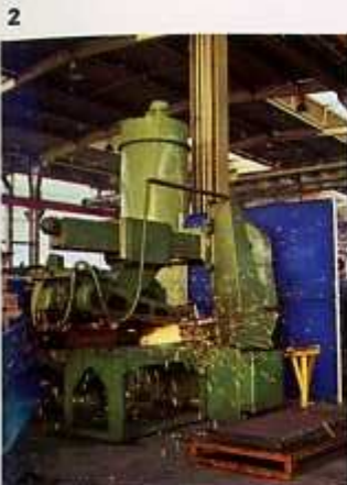
Une tronçonneuse à disque abrasif débite les profilés les plus durs.
