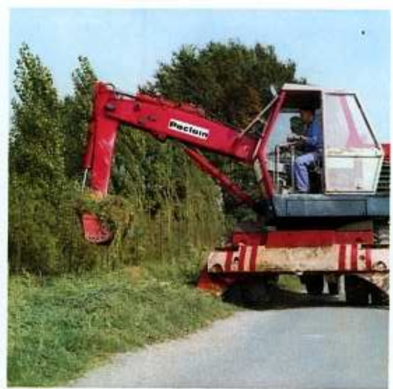
Montage court, qui diminue l'encombrement sur route, pour la création d'un fossé large avec le godet 1,50 m.
