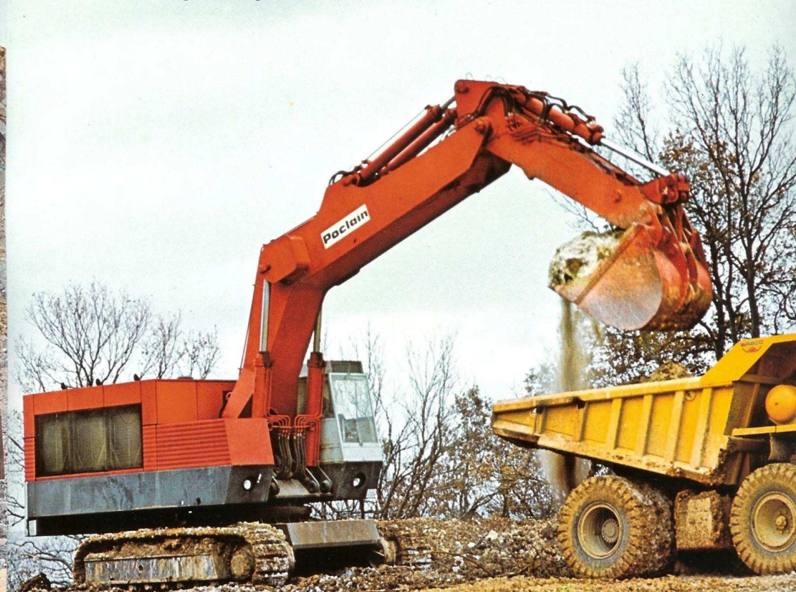
EC 1000 effectuant la découverte dans une carrière de calcaire. Godet 5000 l. Rendement horaire moyen : 800 à 1 000 t./h.
