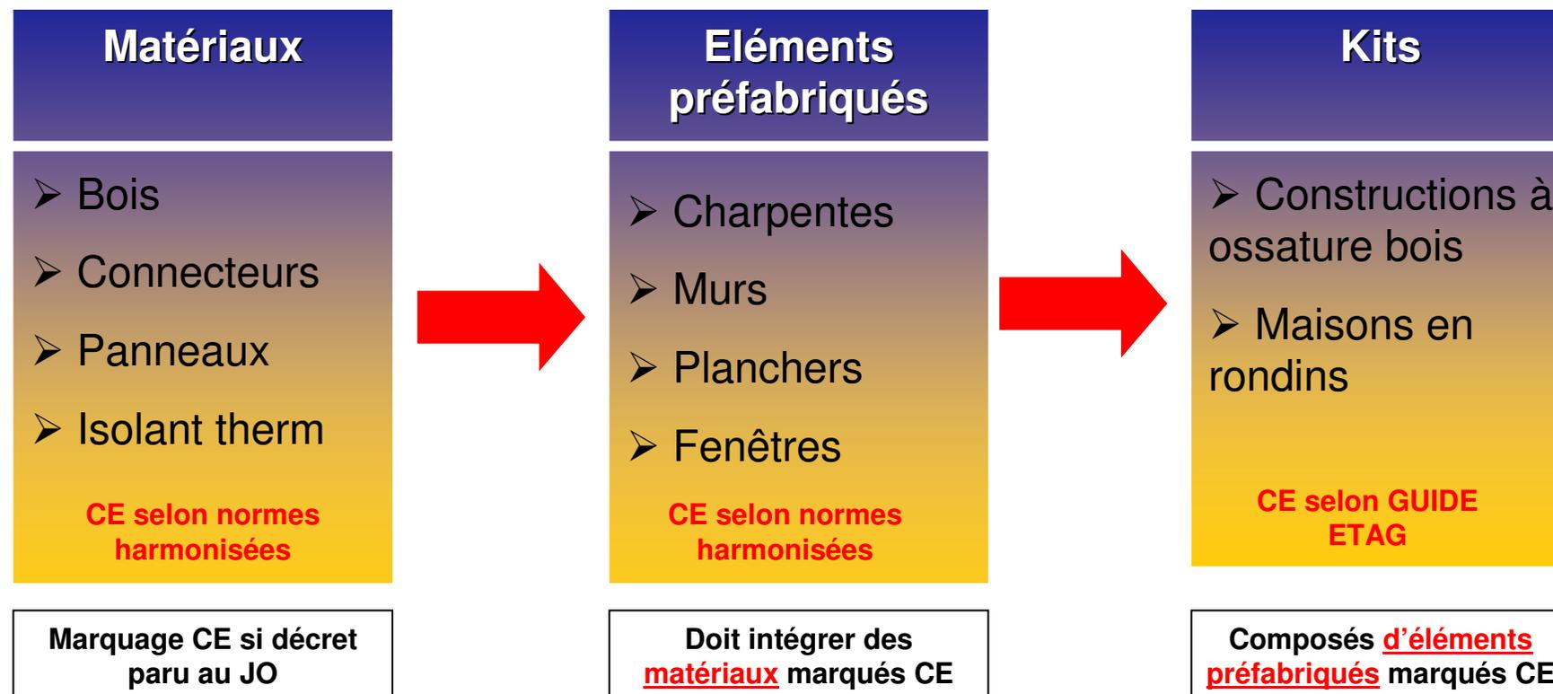
**Tout ouvrage à ossature bois est constitué d'un kit de construction devant être marqué CE avant sa mise en œuvre sur le chantier**
