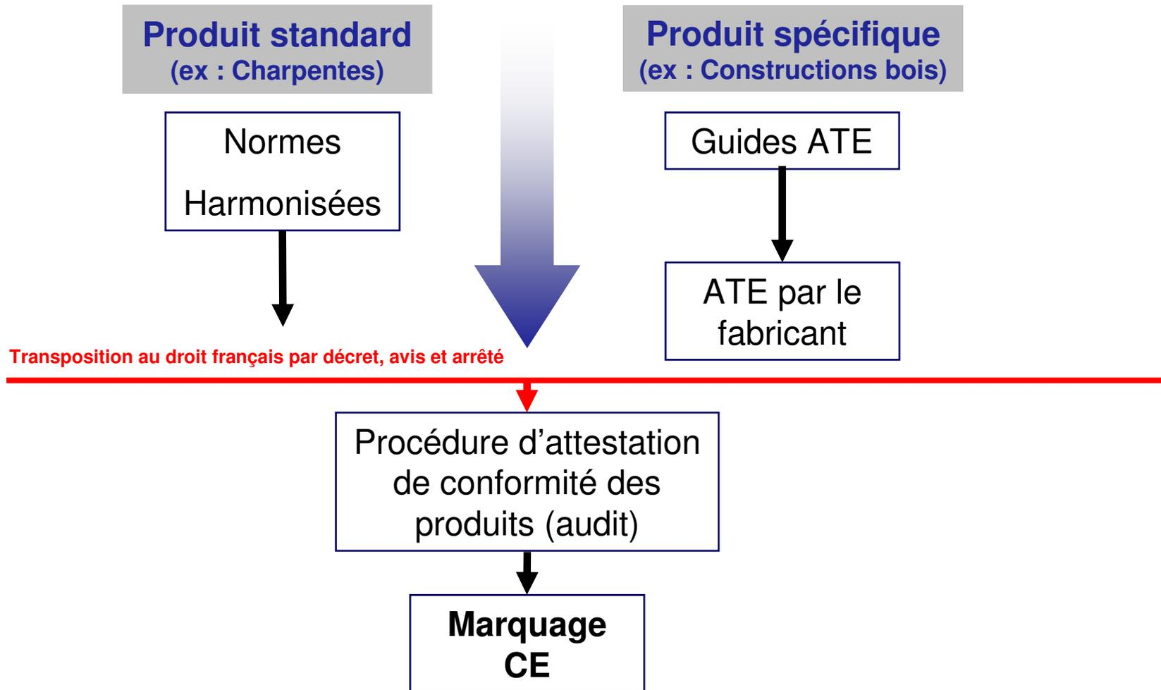
*Le marquage CE des produits de construction à ossature bois nécessite préalablement un ATE (Agrément Technique Européen)*
