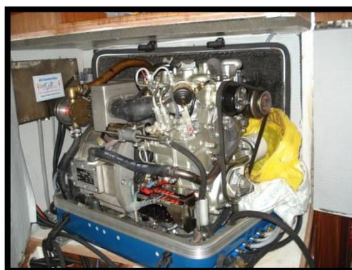
Pour faire le plein d'huile (+/- 1,6 litres de 10w40), pas possible de verser non plus. Je le fais donc à la seringue de 60cc (seringue à gavage pour les IDE) avec une sonde naso-gastrique. Je laisse calculer le nombre de seringue nécessaire.
