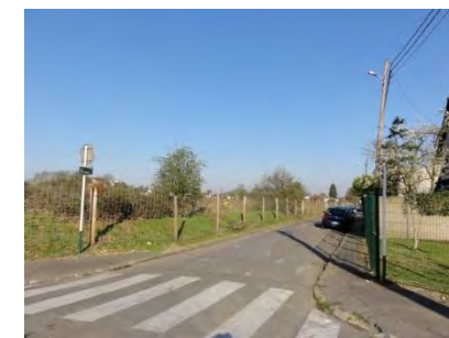
Traversée piétonne non conforme aux recommandations en vigueur – Angle rue Jules Ferry/ rue de la Justice
