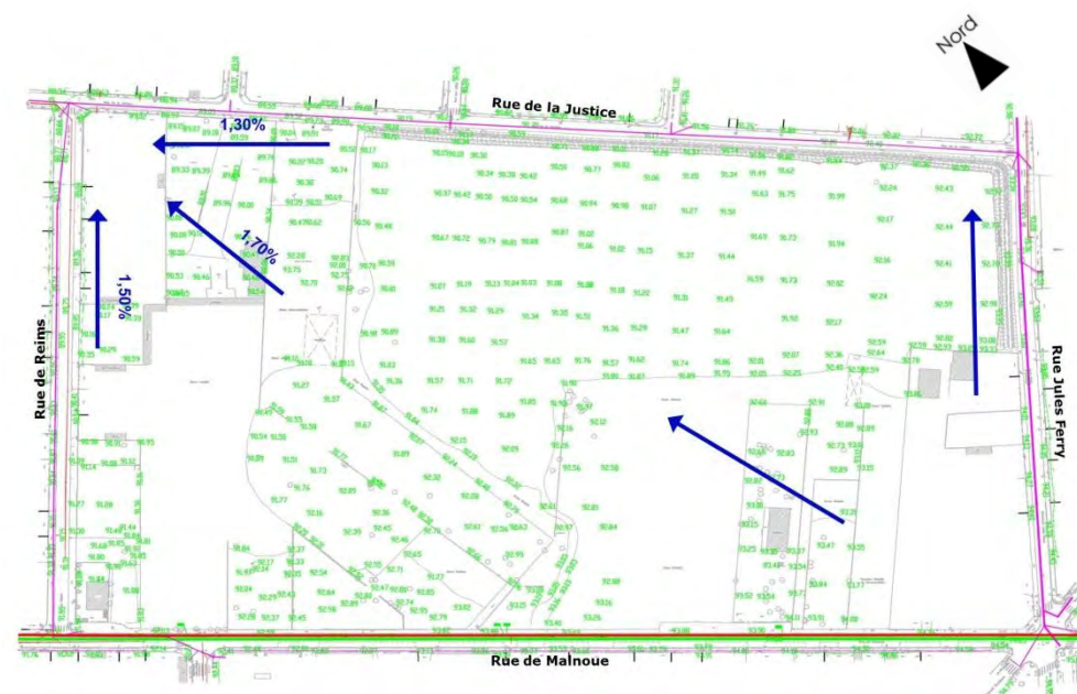
Plan de l'existant : topographie et réseaux EP/EU Source : ATM
