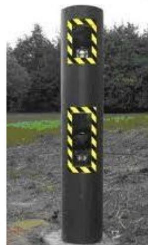
Le **radar discriminant poids-lourds** est un radar automatique un peu particulier car il est capable de flasher les poids-lourds à une vitesse différente des véhicules légers (voitures, motos, fourgon ...) En effet, la cabine radar intègre une antenne de détection des poids lourds qui permet au radar de classer les véhicules selon deux catégories dites VL et PL.
