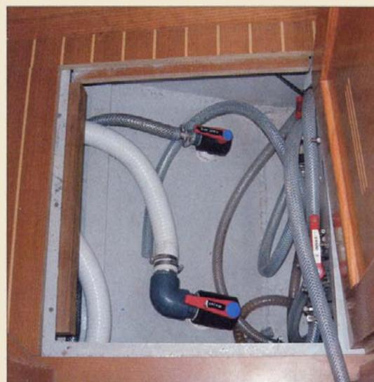
**A éviter : monter la prise d'eau des toilettes juste derrière l'évacuation !**
