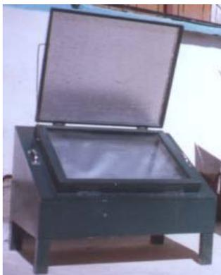
Boîte isolée avec double vitrage et tôle noire au fond pour produire l'effet de serre. Simple à construire à partir de matériaux que l'on trouve partout : bois, contreplaqué, aluminium ménager, verre et laine de mouton (pour l'isolation). On peut atteindre une température autour de 130° C avec ce modèle simple.
