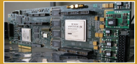
Partie bande de base d'IDROMel
