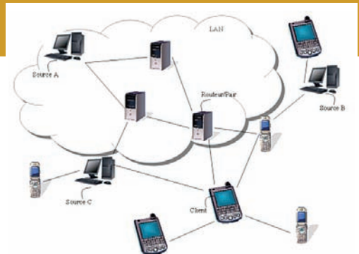
Architecture de routage hybride filaire/sans fils avec serveurs et pairs
