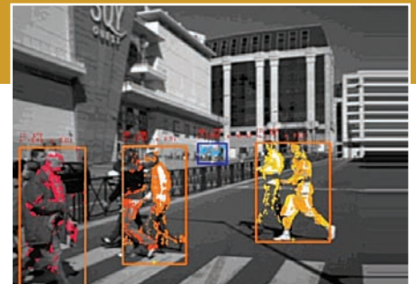
Détection (préalable à la localisation) et localisation d'objets par stéréovision (Résultats du LVMC)
