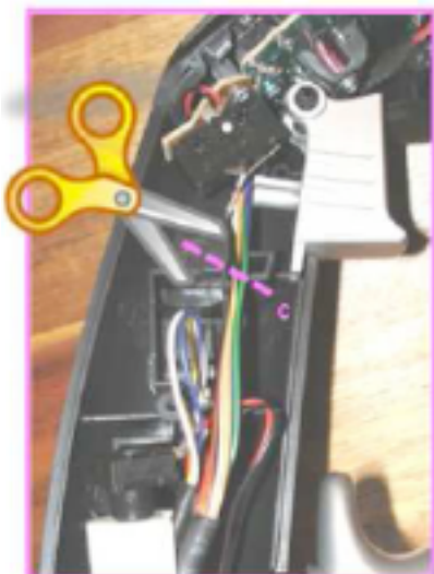
Démontage du manche et modification du câblage
