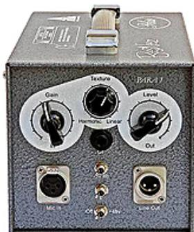
distorsion par harmonique 2 et 3 à – éventuellement – ajouter au signal entrant, cela afin d'obtenir des couleurs sonores très différentes : sonorité moderne très propre (gain sur 3, texture sur 9 et niveau de sortie sur 3), son très chaud (gain sur 5, texture sur 5 et niveau de sortie sur 3), son allemand des années '70 (gain sur 5, texture sur 4 et niveau de sortie sur 5), son américain de la fin des années '50 (gain sur 4, texture sur 1 et niveau de sortie sur 5), etc. (...)
