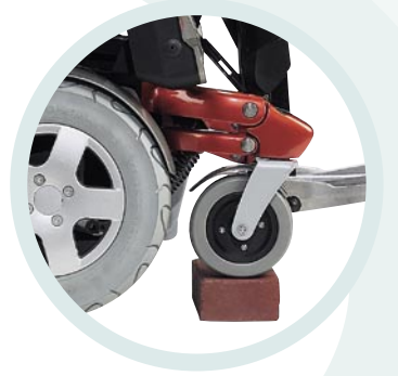
Le Système "Walking Beam" permet le franchissement d'obstacles en douceur et sans monte trottoir.
