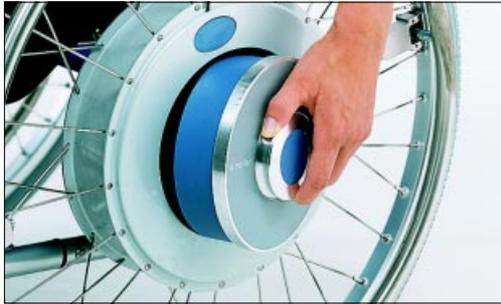
Démontage du pack batteries en position assise
