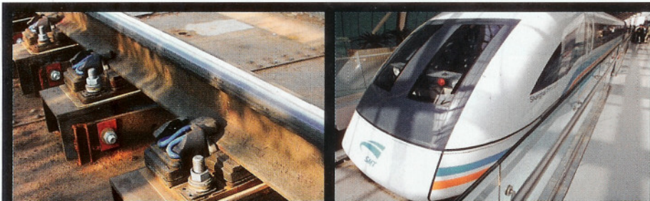
Les absorbeurs de vibration sont destinés à réduire le bruit du roulement. Plus silencieuse, la sustentation magnétique n'est exploitée qu'à Shanghai.
