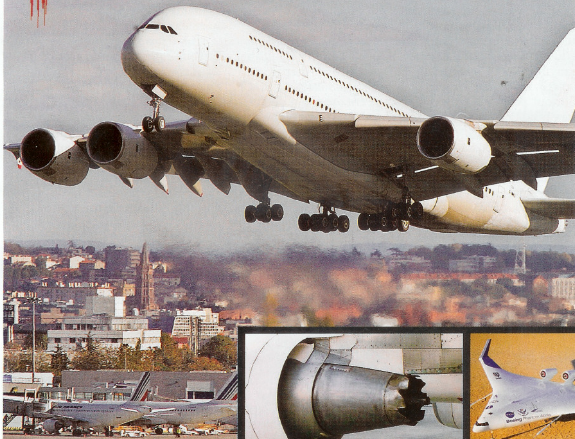
La tuyère à chevrons, un exemple d'améliorations apportées sur les réacteurs. Piste d'avenir: l'aile volante, sans empennage et avec des réacteurs sur le dessus.
