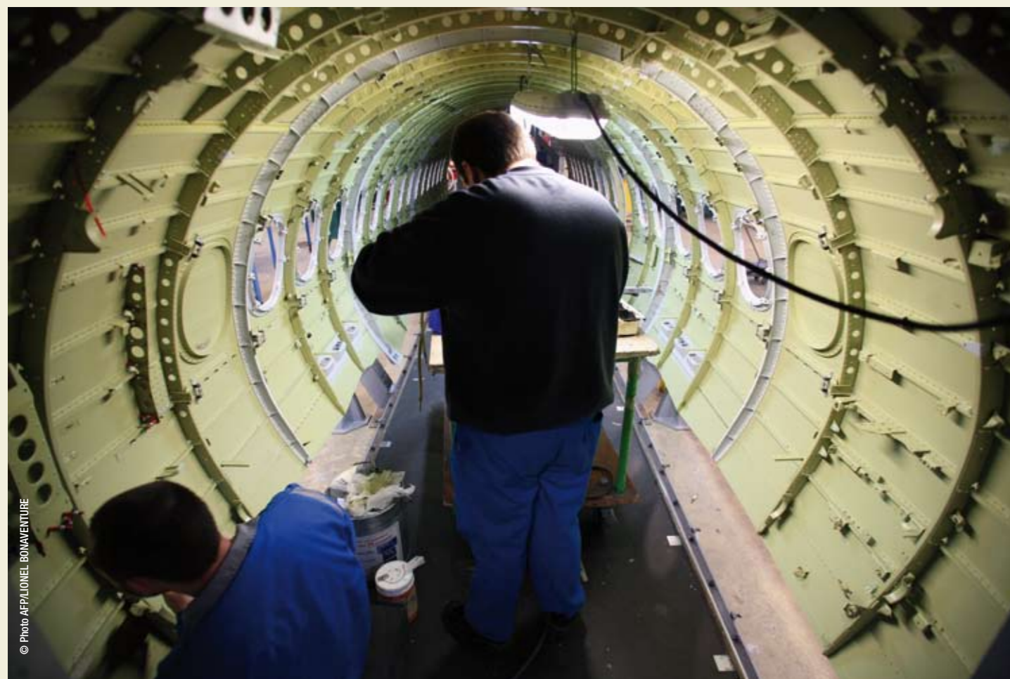
Chaîne d'assemblage de la version 2008 du TBM 850 d'EADS Socata, nouvel avion d'affaires à turbopropulseur de six places à grande vitesse. Le Socata TBM-850 est désormais le monomoteur le plus rapide du marché (600 km/h à 7 800 m). Ses performances sont comparables à celles des jets légers pour une complexité inférieure et un coût d'exploitation réduit.
