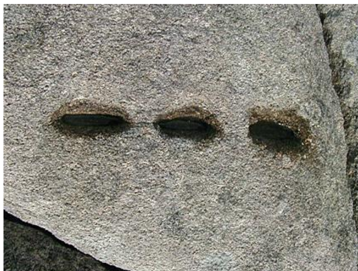
Alignements de trous pour coins de bois ( à droite ) et de fer ( à gauche ) Photos Jean Plaine
