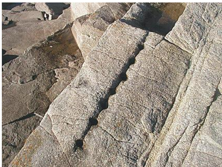
Alignements de trous pour coins de bois ( à droite ) et de fer ( à gauche ) Photos Jean Plaine
