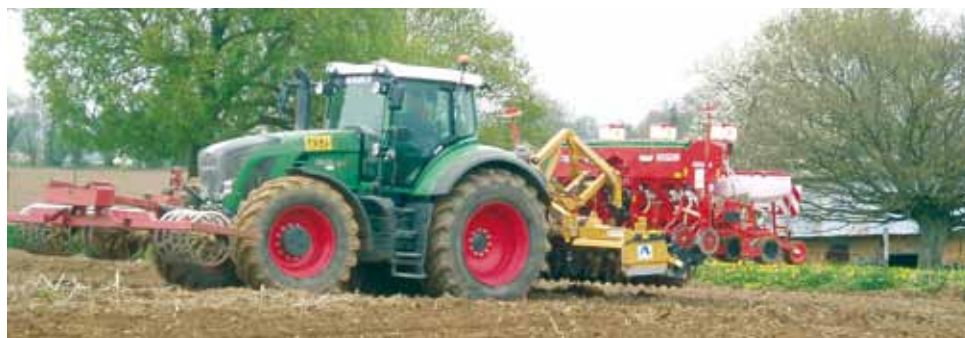
La mémorisation des séquences du relevage et des distributeurs hydrauliques fait gagner du temps lors des manœuvres en bout de champ.
