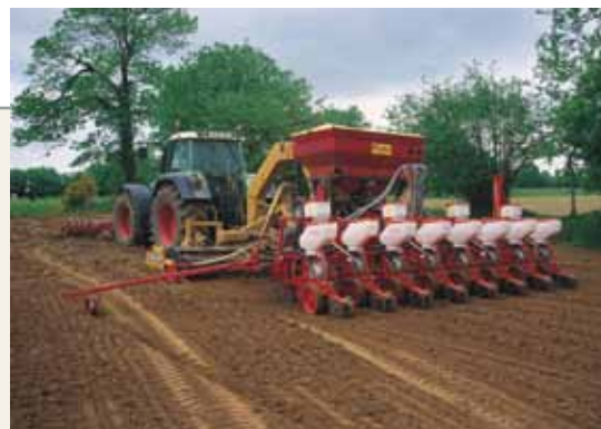
Les entrepreneurs ont mis au point un chariot porte-outils pour le semis de maïs en combiné.
