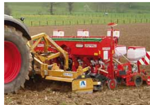
La trémie à engrais de 1 000 litres procure une autonomie de 10 hectares. Cette grande capacité limite les temps morts liés au chargement et contribue à améliorer le débit de chantier.
