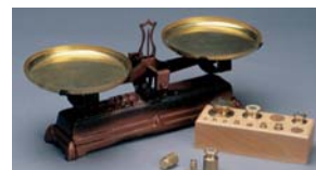
Balance Roberval et boîte de masses marquées : 12 masses en laiton de 1 g à 5 hg.
