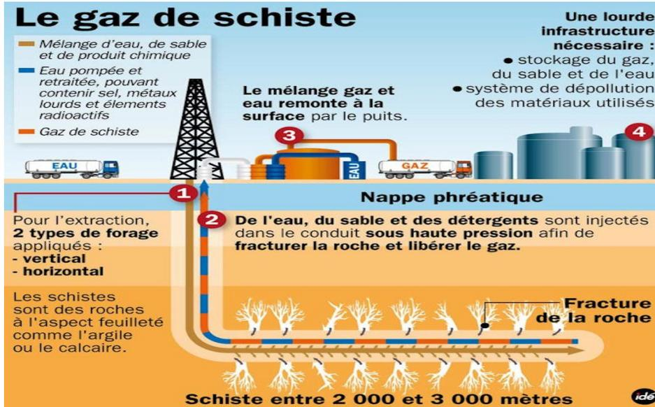
La «fracturation hydraulique horizontale», consiste à provoquer des failles à l'aide d'un liquide envoyé à très forte pression, pour libérer le gaz et le pétrole pris dans la roche compacte, à environ 3000 mètres de profondeur.
