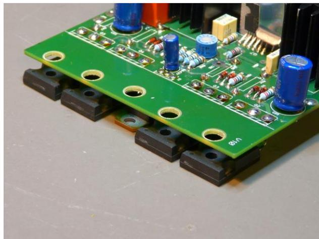
Une fois la carte fixée sur le radiateur, avec les entretoises ad hoc, placer les transistors et les isolants, et souder.
