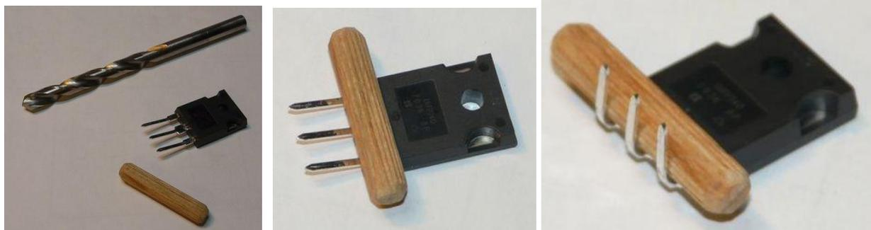
Puis, placement sous la carte, on voit bien l'intérêt de pré-percer les trous à 6 ou 7 pour laisser passer la tête de vis à travers le circuit imprimé (ici, ce n'est pas fait !). Les entretoises de 10mm permettent de bien dégager les résistances de puissance.
