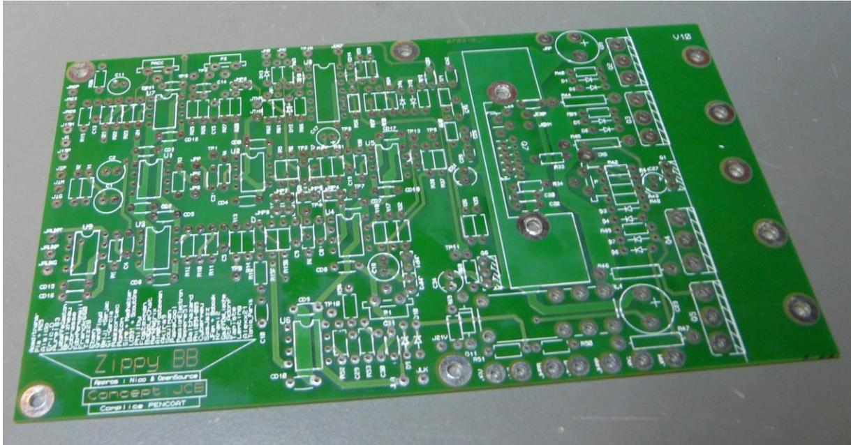
Avant tout, vous devrez déterminer quelle sera votre mode de montage des transistors de puissance. Si ceux-ci sont montés verticalement sur la carte, vous aurez éventuellement à vous débarrasser de l'extrémité de la carte, percée de 5 trous (à droite sur la photo ci-dessus).
