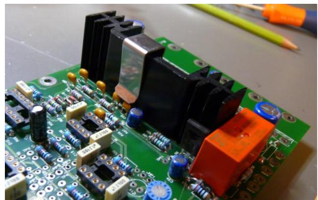
Montage des transistors de puissance :
