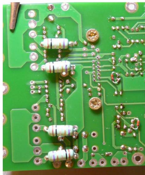
Il faut aussi rajouter deux diodes en parallèle sur les condensateurs de  $10\mu\text{F}$  C21 et C34. Les cathodes (trait noir) sont en bas sur la photo ci-dessus. Les anodes sont au 0V.
