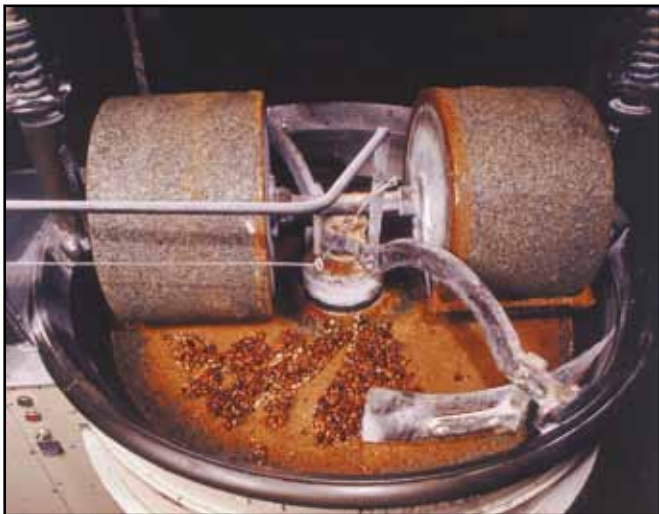
Broyage du praliné sous des meules en granit à la Chocolaterie Michel Cluizel
