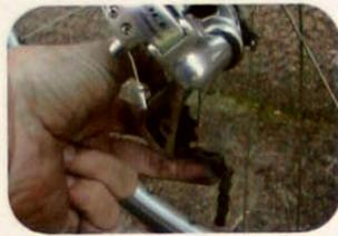
**4 -** Après passage derrière le galet inférieur, **tirer la chaîne** de façon à ce que les deux bouts se joignent entre plateau et galet. Pour éviter qu'elle ne se déplace en s'enroulant sur la roue libre, il est possible de la bloquer en actionnant la manette du dérailleur avant vers le plateau médian.
