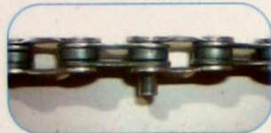
**6 -** La chaîne est maintenant en place sur la transmission, l'axe dépasse de votre côté, **il ne reste plus qu'à le remettre en place à l'aide du dérive-chaîne** qui ne mérite plus son nom.
