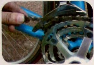
**1 - Positionner la chaîne** de façon à ce que l'axe qui dépasse du maillon extérieur soit vers vous, ceci pour faciliter la manipulation du dérive chaîne en fin d'opération !
