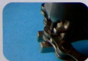
**2 - Visser la poignée** jusqu'à ce que le poinçon vienne en contact avec l'axe du maillon. Avant de continuer l'opération, **vérifier que le poinçon est bien en place**, au milieu de l'axe.
