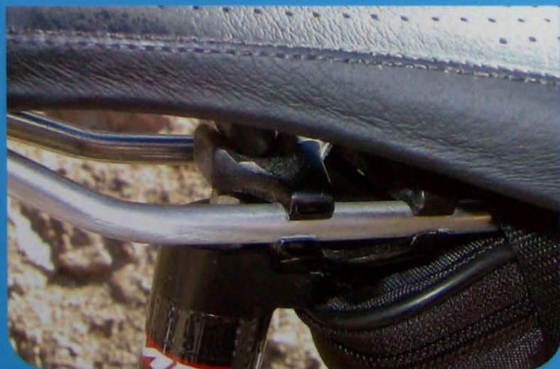
▲ Bonne combinaison ! Il est possible d'avancer ou de reculer la selle en respectant les limites de sécurité.
