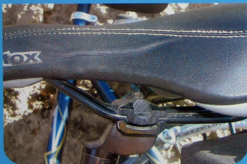
▲ Impossible de reculer la selle ! Son centre est bien dans l'axe du tube, mais elle présente un important et dangereux porte-à-faux. Cette combinaison mériterait une tige de selle plus déportée vers l'arrière.
