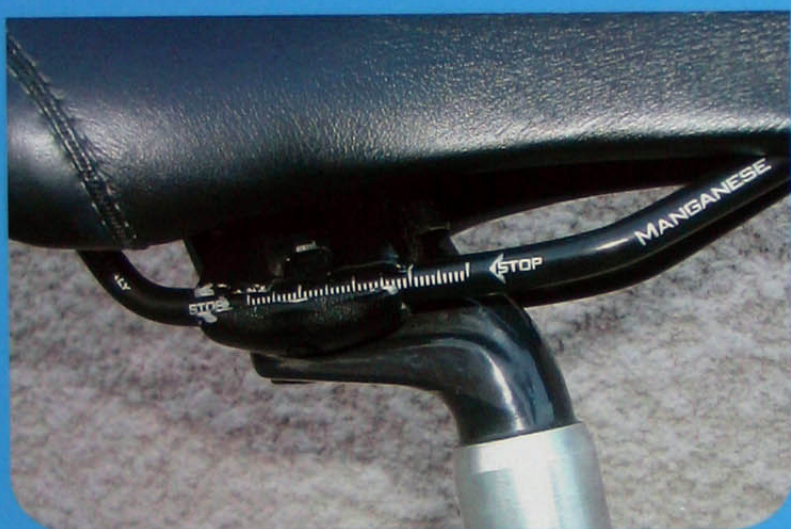
▲ Cette combinaison selle/tige ne permet pas d'avancer la selle ! Ici elle est positionnée hors des limites de sécurité !
