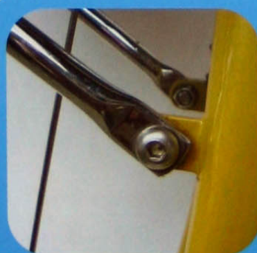
▲ Fixation des porte-bagages évitant les colliers.
