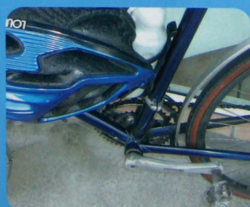
▲ Arrière long permettant de démonter facilement la roue.
