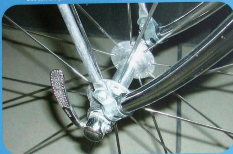
▼ Des colliers pallient la faiblesse d'équipement du cadre.
