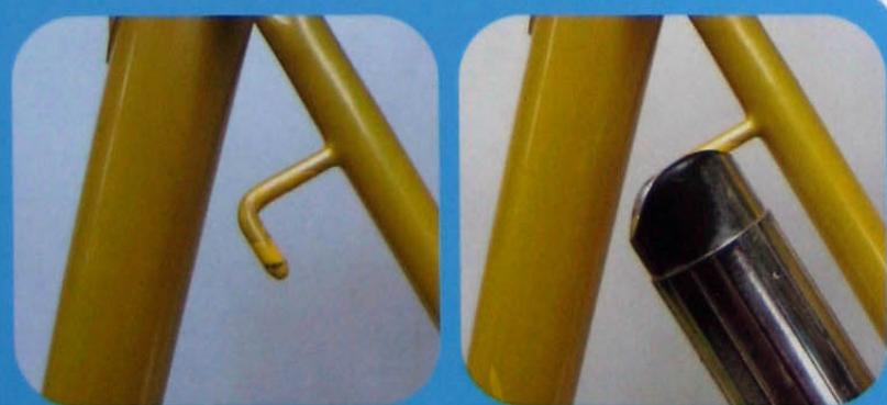
▲ Fixation simple et efficace d'une pompe.
