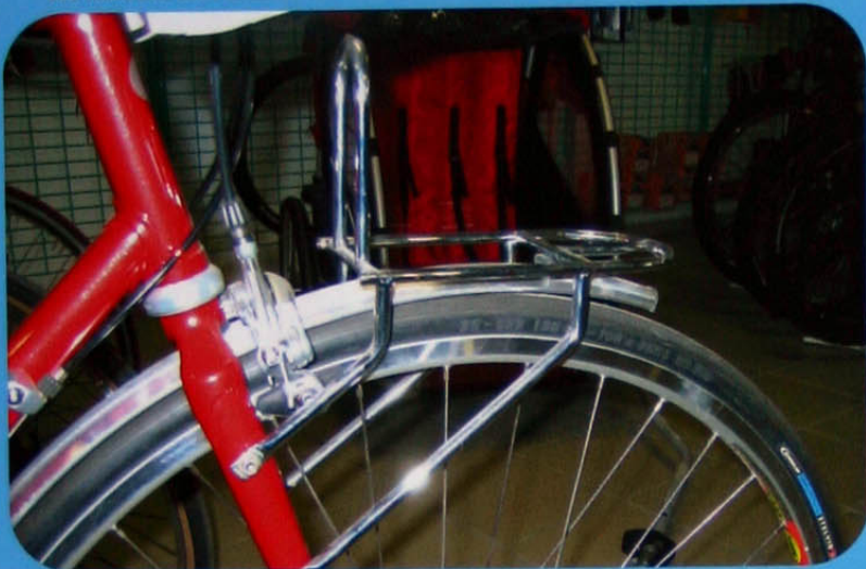
▼ Les fixations sont brasées sur le cadre.
