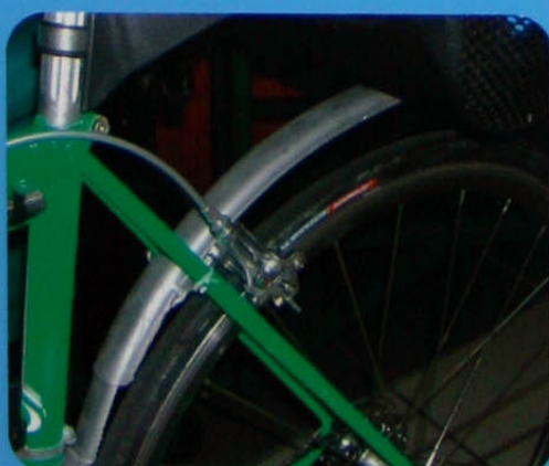
▲ Garde-boue "bricolé" dangereux et inefficace !
