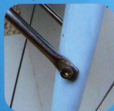
▲ Fixation des porte-bagages évitant les colliers.
