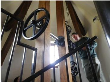
En arrivant au dernier étage, il y a le même mécanisme que sur le toit mais en miniature. C'est en actionnant ce dernier que le manipulateur actionne celui du toit. Un deuxième système plus petit est situé au-dessus. Il permet au manipulateur de se faire un aide-mémoire.
