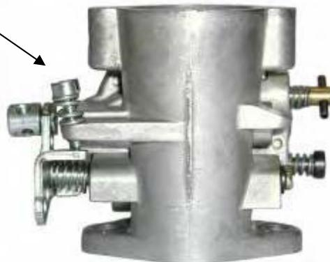
Vis de Haut Régime (H) : 1 tour  $\frac{1}{4}$  et rechercher le « 4 temps ». Supprimer progressivement le « 4 temps ». Régler la vis de haut régime nécessite d'effectuer plusieurs tours de circuit.
